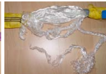
durch Überlastung gerissene Rundschlinge
