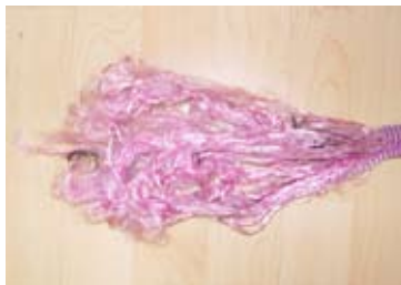
durch Überlastung gerissenes Hebeband
